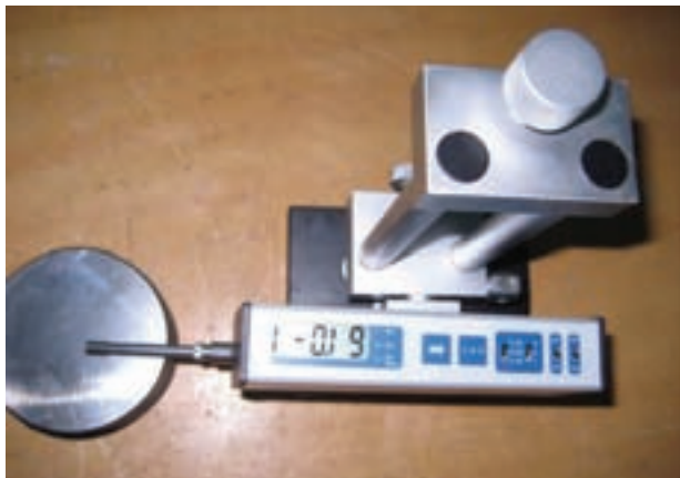
b - زبری سنج در حال اندازه‌گیری زبری
